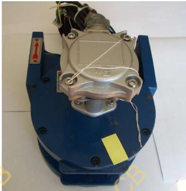
Рисунок 4. Порядок пломбирования скоростного измерителя объема ТРК «Шельф»
